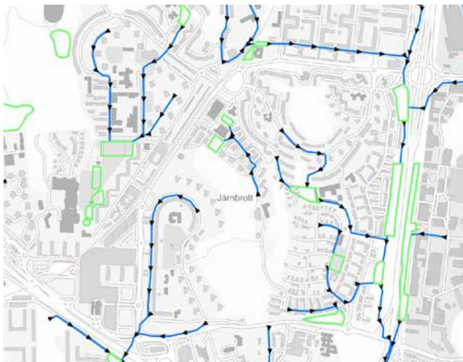
Bild: Skyfallsleder och skyfallsytor för att undvika scenariot vid ett klimatanpassat 100-års regn (Källa: Göteborg stad)
